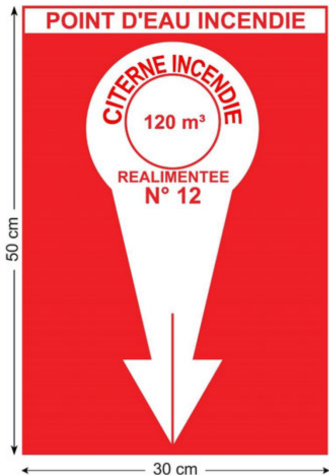
Réserve réalimentée Vanne dans le rayon de 1 mètre
